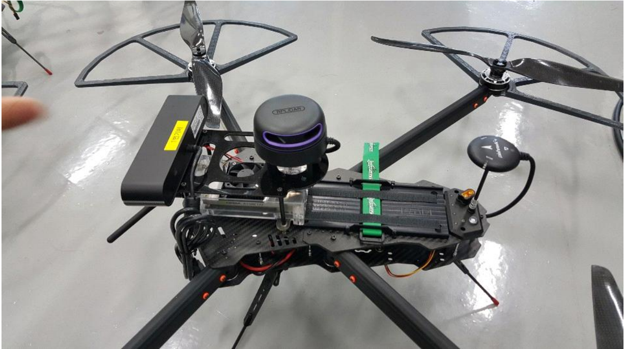
그림 4. 본 연구팀이 보유 중인 라이다, 비전 센서가 연동된 드론
