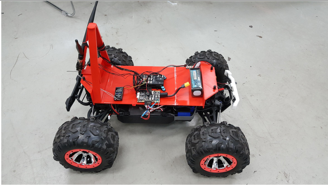
그림 7. FCC와 센서 모듈 등이 통합된 4륜 구동 주행 로봇 예시
